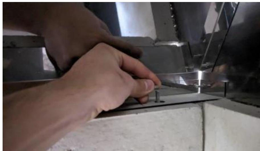
8. Уложите огнеупорную вату (фольгированная часть должна быть сверху) и дистанционные ножки для чугунной вставки модуля «Жаровня».
