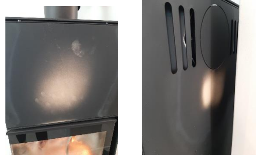
Изображение 10. Примеры обесцвечивания, вызванного перегревом устройства.
